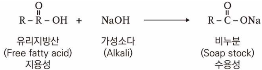
그림 6. 알칼리 탈산에서 유리지방산과 가성소다(NaOH)의 반응으로 생성되는 비누분
